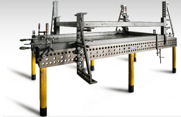
präzise Schweißkonstruktionen mit Hilfe von gehärteten Schweißtischen
